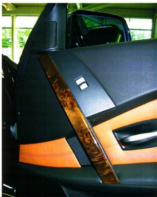
图一. 为使可顺序性地充模及避免损坏此敏感性的真实木制内饰条, INCOE 使用了液压油缸驱动的阀针式热流道系统。
