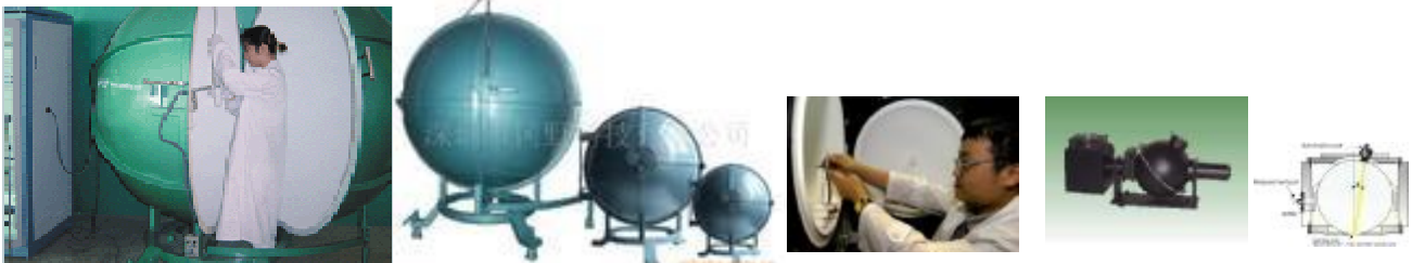
各种不同尺寸的积分球,除了微型积分球外其它尺寸的积分球光源必定放在正中间
