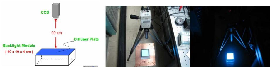
以 CCD 來記錄全過程時，我們可以發現 LED 的發光角度與擴散無關，能穿透擴散板的發光角度是固定的，從中心點的亮斑可以看出來  $0^{\circ}$  角的最為明亮，隨著角度越大而減弱。
