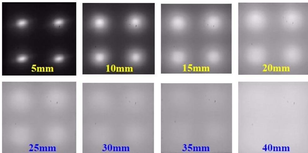
經上述實驗中，不論你用那一種基材製成的擴散板均可達到擴散目的，只差別在光源到板的高度上，但光效要好還是基材折射率越小出光率越高，也在已知光源離板越高配光曲線越小，光經介質角度只會變大不會變小，光通量只會減少不會增加的物理現象，所以需知道客戶要求的配光曲線，看自己的設計是否符合再來選用擴散板或混光板。
