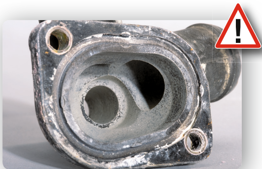
被水垢覆盖的管路
