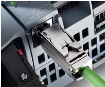
集成的 PROFINET 接口用于编程、HMI 通讯和 PLC 间的通讯。此外它还通过开放的以太网协议支持与第三方设备的通讯。该接口带一个具有自动交叉网线 (auto-cross-over) 功能的 RJ45 连接器，提供 10/100 Mbit/s 的数据传输速率，它支持最多 16 个以太网连接以及下列协议：TCP/IP native、ISO-on-TCP 和 S7 通讯。
