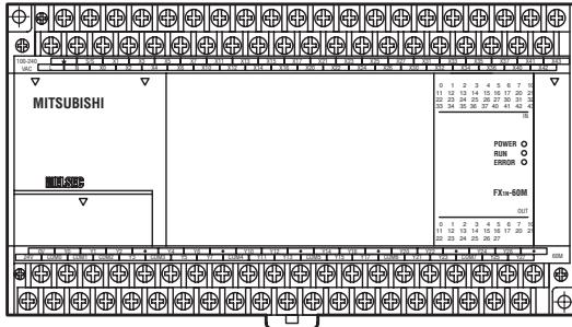
FX1N-60MR-ES/UL [ OV Y0 Y1 Y2 • Y4 Y6 • Y10 Y12 • Y14 Y16 • Y20 Y22 • Y24 Y26 • ]
