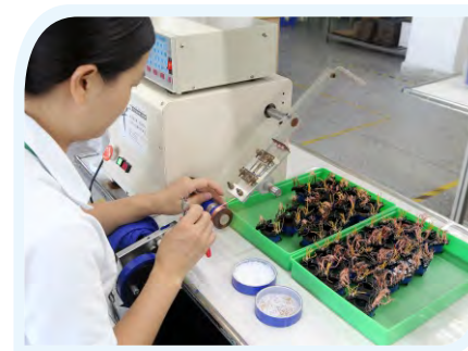
01 变压器绕制 / Transformer Winding
