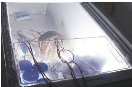
LED工矿灯实验中的数据低温实验 (-20℃)
