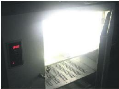
LED工矿灯实验中的数据高温实验
