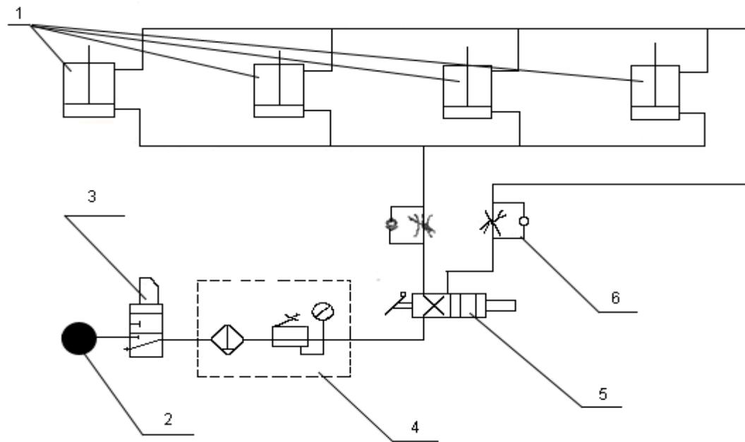
1. 顶网气缸 Screen rise cylinder 2. 气源 compress air 3. 气源通断夹 compress air switching 4. 水隔组合
