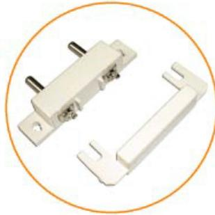
原理：对一个地面或者限定的空间进行防漏水探测的原理是，如果有浸水，水会接触到两条金属探头，水和金属都是导电物质，线路就会接通，开成一个通路信号传给处理器进行报警。
