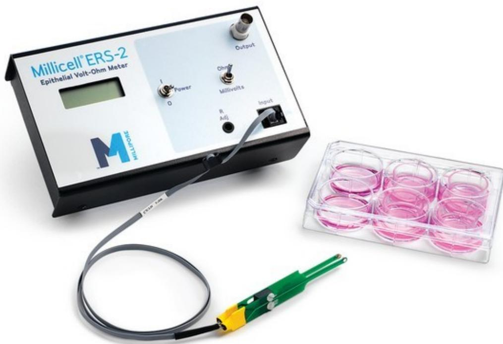
Millicell-ERS 电压电阻表，又名 Millicell-ERS 伏特欧姆计。该套设备主要由电阻测量仪和测量电极组成，用于测量 Millicell 插入式细胞培养皿中的细胞膜电压和跨上皮细胞电阻。电阻读数不受膜电容和膜电压影响；系统采用交流电，避免了对组织产生不利影响；在电极上不会有金属沉淀；细胞上零净电荷消除了直流电流在细胞膜上的不利影响。
