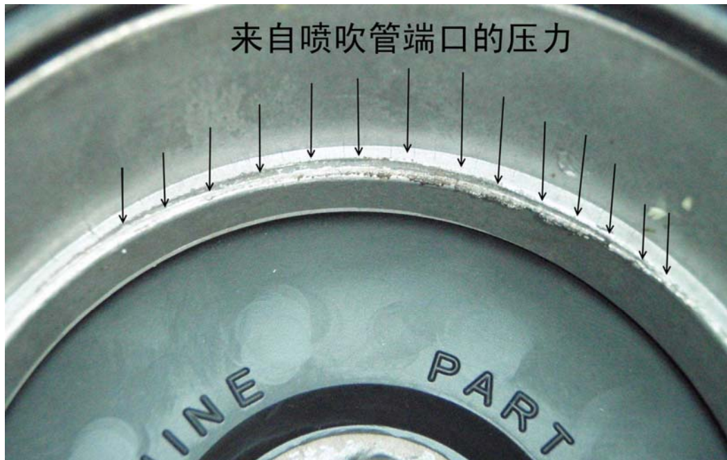
图 7. 喷吹管端口直接顶住阀座，由于外部被大力锁紧，喷吹管把阀座顶出一个严重凹槽
