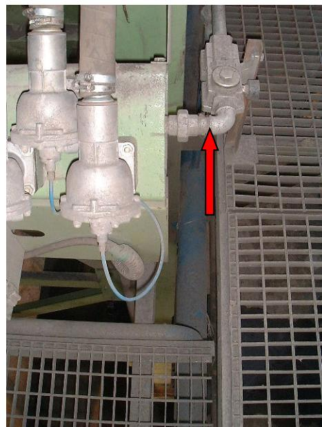
图 8. 进气管口径太小，造成补气不足
