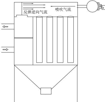
图 11. 阀门在气箱式除尘器上喷吹后，气箱中形成高压，容易产生逆向气流，反弹撞击在膜片上，引起膜片严重振荡，降低膜片使用寿命。
