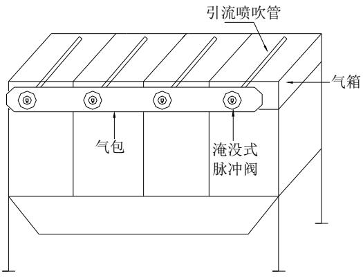
图 10. 在气箱内可制作一条喷吹管与脉冲阀相连，避免逆向气流打到膜片上。
