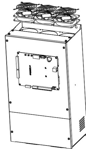
Installing the cooling fan
