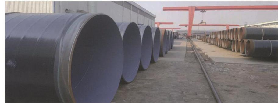
TPEP防腐钢管——外3PE内熔结环氧防腐钢管是在外单层聚乙烯内环氧复合钢管的基础上升级换代产品，是目前埋地长输管最先进钢管防腐形式。是沧州兴昊管道自主开发的第四代大口径管道新型防腐生产线。外壁采用热熔结缠绕工艺底层环氧树脂、中间层胶粘剂、外层聚乙烯形成三层结构的防腐层，内壁采用热喷涂环氧粉末防腐方式。将粉末经高温加热结后均匀地涂敷在管体表面上，形成钢管合金层，简称TPEP钢管。（T，三层英文Threads的首写字母，PE指聚乙烯，EP指环氧树脂）。极大提高了涂层附着力及涂层厚度，增强了耐磕碰、耐腐蚀的能力。该产品于2016年获取国家实用新型专利。
