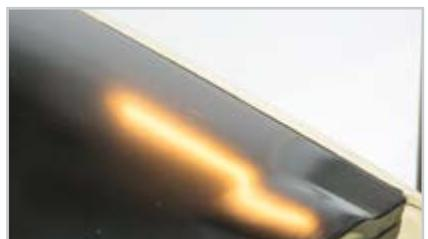
加热加速固化
