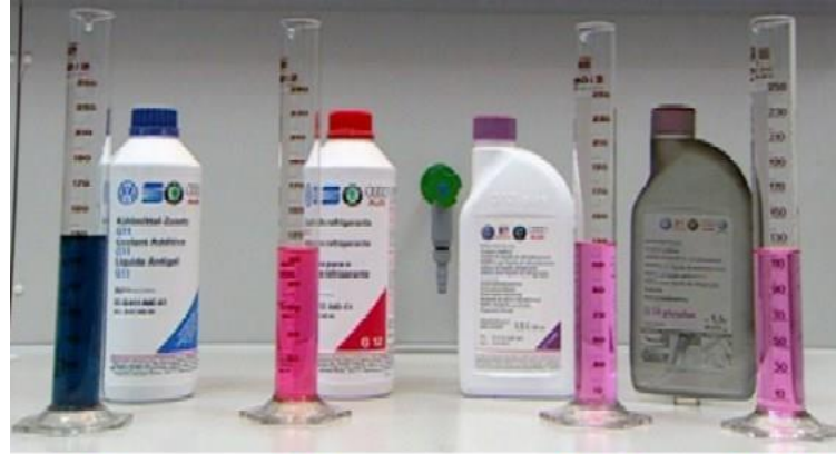
图1. 每种发动机冷却液的颜色。G11(G48):蓝绿色、G12(G30):红、G12+(G30)、G12++(G40)、G12evo(G65)和G13(GG40):紫色。
