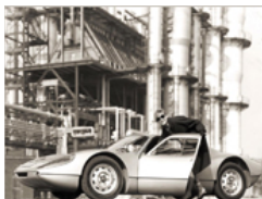
1964 年采用 Palatel 制造的保时捷跑车。其车身由巴斯夫 Palatel 合成树脂制成。
