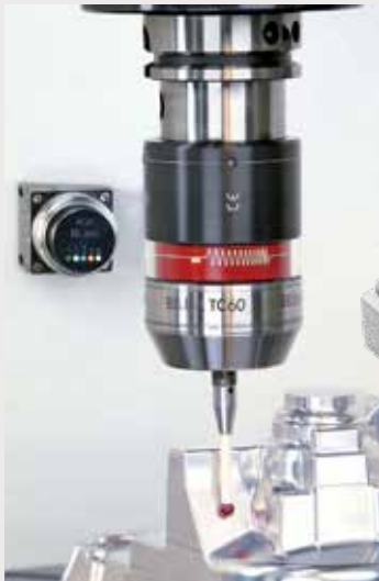
五軸立式研磨中心機，動態精度測量和補償系統。
