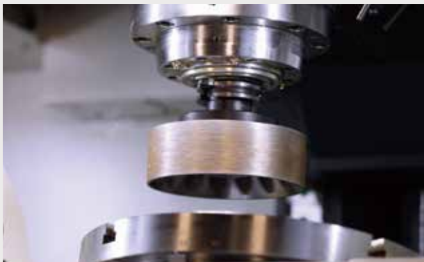
可應用不同材料砂輪，如 CBN、氧化鋁或鑽石砂輪。
