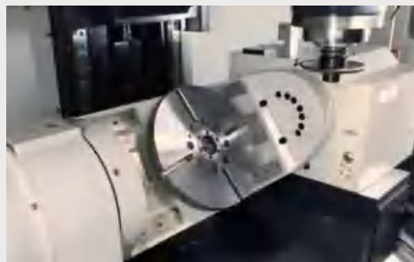
五軸研磨中心機，符合工件多角度加工的需求，整合繁複工序，完成一次裝夾的加工。
