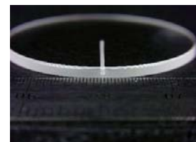
蓝宝石材料上加工 Φ0.5mm/15mm密孔
