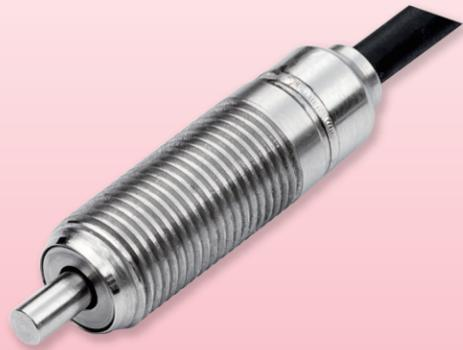
SDVH8 位置开关用于产品的外形尺寸的测量，可单独使用，输出开关信号。也可配变送器使用，变送器可配备多只位移传感器，变送器对采集到的位移传感器信号进行分析处理，得到被检测的产品的外观尺寸数据，同时给出结构尺寸是否合格结果，如果需要还可以进一步给出修正的相关信息。
