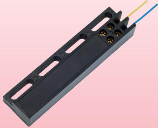
双稳态位置开关多用于电梯的平层和井道，为电梯升降的限位控制用。由于采用了干簧管技术，克服了机械式开关容易损坏的缺陷，具有高可靠性、长寿命、响应迅速、不耗电、安装接线方便等优点。
