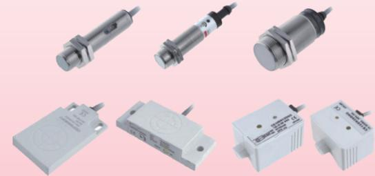
电容式接近开关的感应面由两个同轴金属电极构成，该两个电极构成一个电容，串接在 RC 振荡回路内。电源接通时，RC 振荡器不振荡，当一目标朝着传感器感应面靠近时，电容容量增加，振荡器开始振荡。通过后级电路的处理转换成开关信号，从而起到了检测有无物体存在的目的。电容式传感器能检测金属物体，也能检测非金属物体，对金属物体可以获得最大的动作距离，对非金属物体动作距离决定于材料的介电常数，材料的介电常数越大，可获得的动作距离越大。
