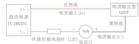
二线电流输出型接线图(PLC接入):
