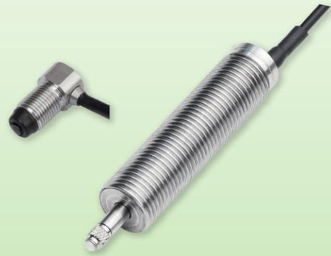
SDHB08-1 等经济型位移传感器用于产品的外形尺寸的测量，在控制使用成本的同时，保证高精度的测量需求。此类位移传感器可单独使用，输出信号 0.5~4.5 V。也可配变送器使用，变送器可配备多只位移传感器，变送器对采集到的位移传感器信号进行分析处理，得到被检测的产品的外观尺寸数据，同时给出结构尺寸是否合格结果，如果需要还可以进一步给出修正的相关信息。
