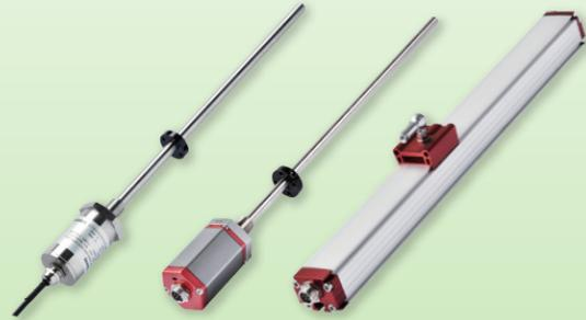
磁致伸缩位移传感器是利用磁致伸缩原理开发的高精度位移测量传感器。采用非接触测量方式、产品使用寿命长，环境适应性强；不需要定期标定和维护；产品为绝对量输出，重启无需归零；具有高精度、高稳定性、高可靠性、高重复性的技术特点；输出支持电流、电压、SSI、Modbus、PROFIBUS等多种输出方式，广泛应用于石油、钢铁、化工、港口、机械和食品等环境恶劣的工业场合，是高精度位移控制的首选。
