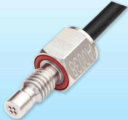
SYP 系列微型压力传感器是一种用来测量绝对压力的、微型的、高灵敏度压阻式压力传感器。隔膜后面的气体被抽出，用玻璃密封，来提供绝对压力参考。满量程输出为 225mV，过载能力强，响应高频高。其测量范围从 15 psia 到 100 psia。压力传感器拥有植入独特的雕刻硅隔膜中四臂应变电桥电位，来实现最大的灵敏度和宽带频率响应。自包含的混合温度补偿可在 0° F 至 200° F (-18° C 至 +93° C) 的温度范围内提供稳定的性能。传感器还具有出色的线性度（即使超 3 倍范围）、高抗冲击性和温度瞬变期间的高稳定性。
