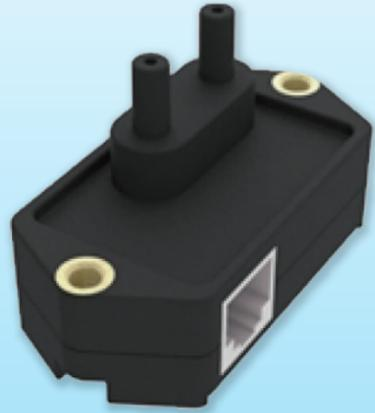
微差压传感器采用进口高精度、高稳定 MEMS 压力芯体，配以单片机、RS-485 通讯电路和控制电路，把两个气体区域的压力差转换为与之成正比的  $4 \sim 20mA$  二线制信号输出，Modbus 标准通讯协议，可进行局域网，通过远程控制，也可直接控制风机设备，调整本地的送风量，智能化的对局部空间的空气质量进行监控调节。适用于暖通空调（HVAC）、能源管理系统、VAV 及风扇控制、环境污染控制、静态管路和洁净室压力、烟雾罩控制、烘箱增压及炉通风控制等领域。
