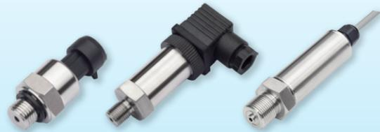
SYP 系列压力传感器是利用金属应变片或半导体应变片粘贴在弹性元件特定表面,当力、扭矩、速度、加速度及流量等物理量作用于弹性元件时,会导致元件应力和应变的变化,进而引起应变片电阻的变化。电阻的变化经电路处理后的以电信号的方式输出,这就是电阻应变式传感器的工作原理,SYP 系列压力传感器选用高精度压力传感器组件,经过内置的电路将传感器受压输出的毫伏信号转换成为标准的电流或电压输出信号。结构上采用全不锈钢一体化焊接工艺,从而确保产品在较恶劣的工况下可长期稳定的工作。
