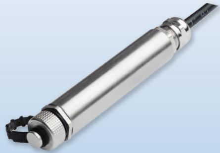
铂电阻温度传感器是利用特殊金属在温度变化时自身电阻值也随之改变的特性来测量温度的，显示仪表将会指示出铂电阻的电阻值所对应的温度值。当被测介质中存在温度梯度时，所测得的温度是感温元件所在范围内介质层中的平均温度。铂电阻温度传感器是最精确和最稳定的温度传感器，它的线性度优于热偶和热敏电阻，最适合对精度有严格要求的应用领域。
