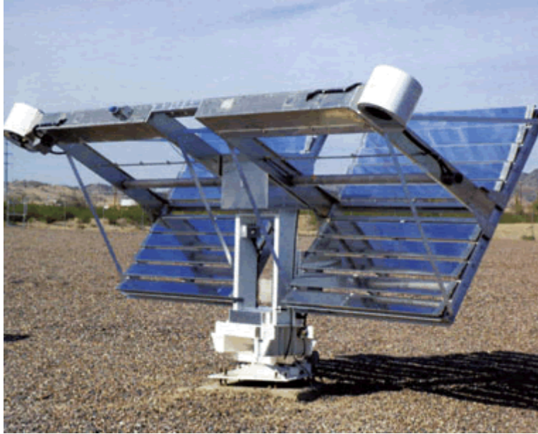
图 3 图为 Q-Lab 的新型 Q-Trac II 自然光聚集器。与传统的室外曝露架相比，该装置通过镜子使得试样受到更为集中的阳光照射。该装置使佛罗里达州 5 年的户外曝露等同于亚利桑那州 1 年的户外曝露
