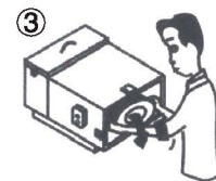
取出高效过滤器
